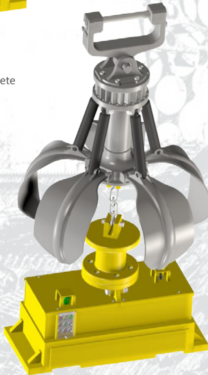
Fig.6 | Mandril de fijación con cadena de seguridad, para fijación mediante un pulpo electrohidráulico
